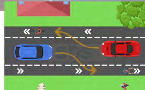
**Voie où les véhicules motorisés circulent sur une voie centrale et les cyclistes sur les bandes de rive.**
