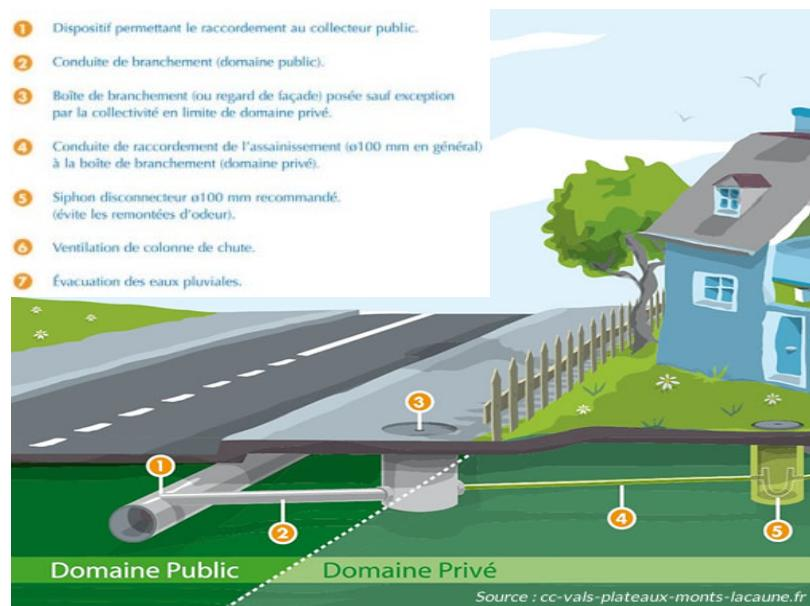
Figure 1 : Schéma boîte de branchement assainissement collectif
