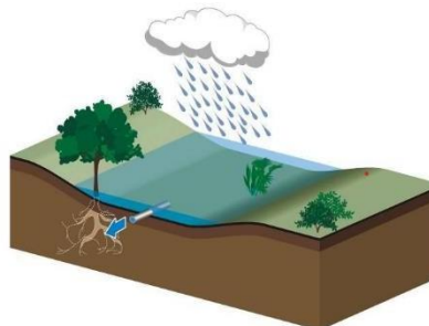
Noue à évacuation superficielle. Le sol est très peu perméable. Les eaux de pluie sont évacuées à débit régulier vers un exutoire via un orifice au pied de la noue. Cet orifice doit être très régulièrement entretenu pour éviter toute obstruction (Source : Architecture & Climat)
